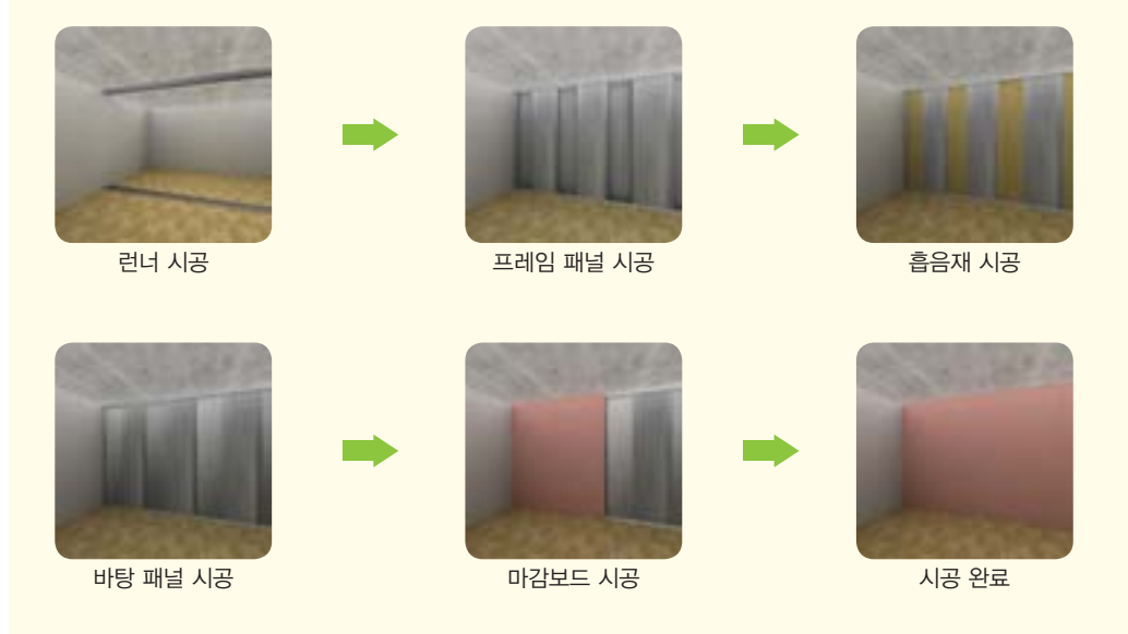
[그림2] 가변형 벽체시스템 표준시공방법
