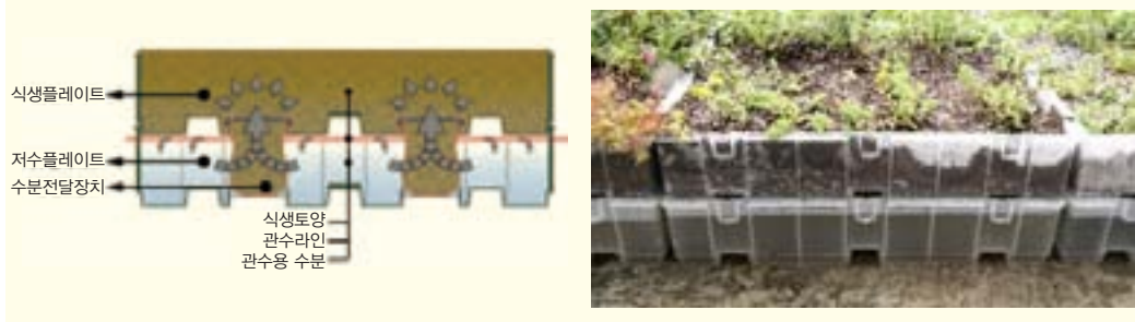
[그림2] 모듈형 빗물저류 녹화블록(GBR: Green Block Rain)
